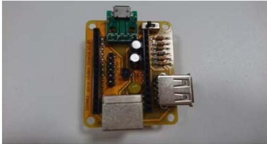
※写真ではC1、C2が電解コンデンサーになっていますが、最新版では積層セラミックコンデンサーに変更されました。
